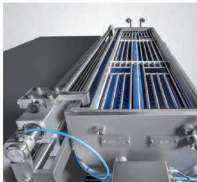
■ Trémie à température dirigée avec double enveloppe
