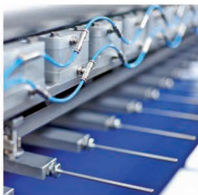
■ Injection horizontale par aiguilles
