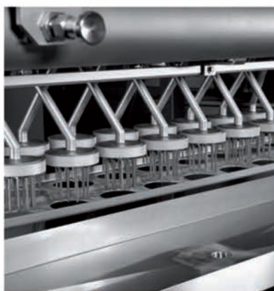
■ Outil d'injection adapté au format produit
