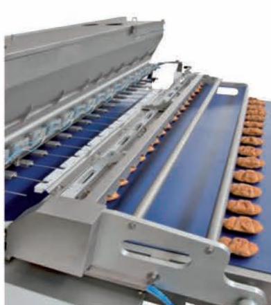
■ Système de maintien et alignement des produits
