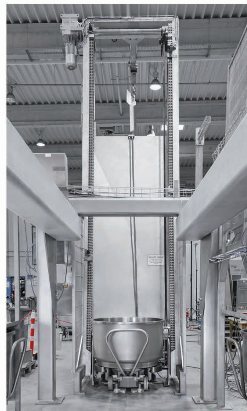
■ Transfert des cuves par élévateur
