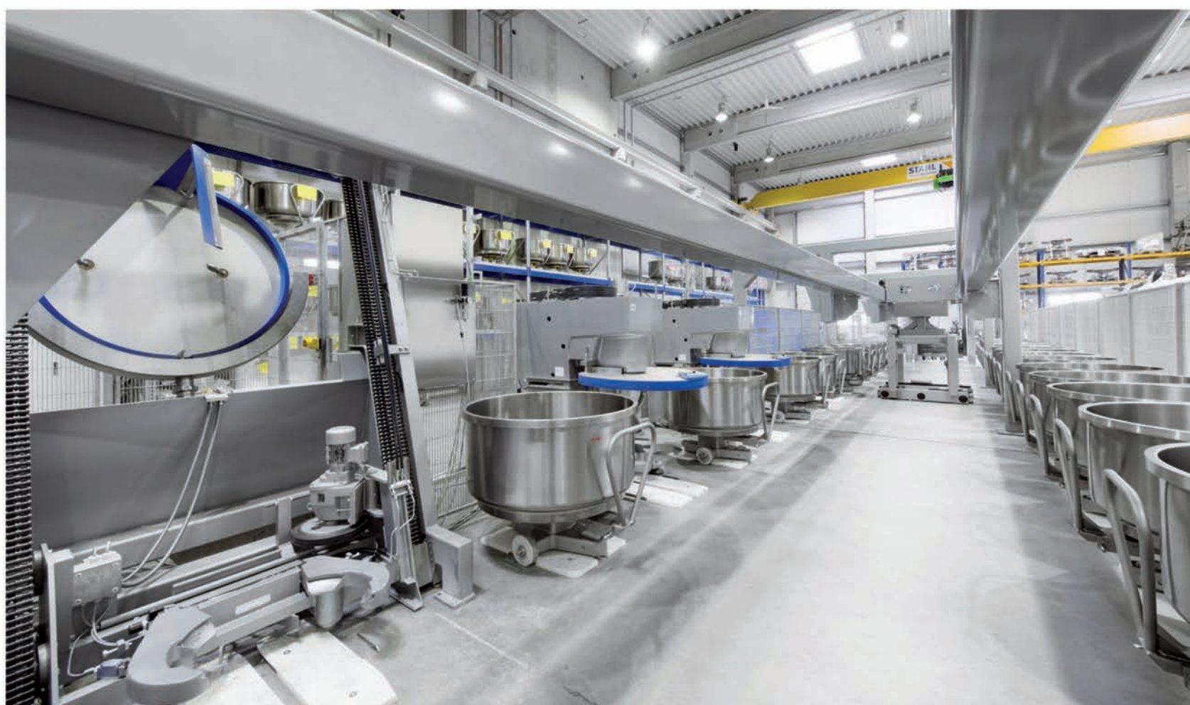
■ Mouvement des cuves robotisées par guidage rails aériens
