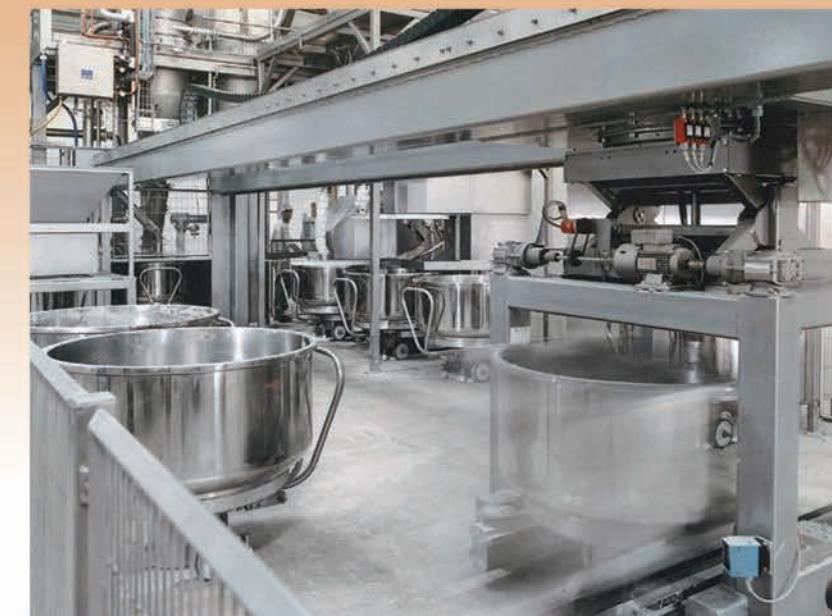
■ Robot de transfert automatique des cuves
